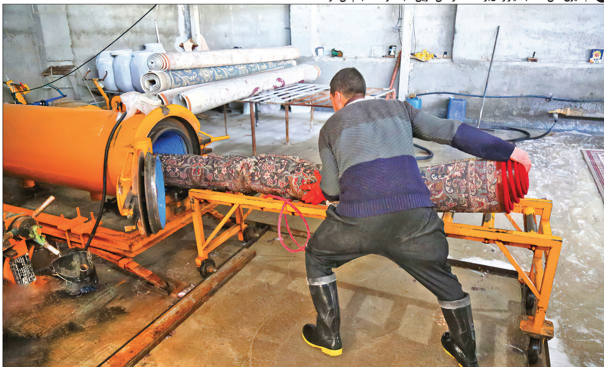
● قالی شویی ها، به کمک ابزار صنعتی، قالی ها را بهتر و سریع تر می شویند ● آبگیری قالی ها که بسیار زمان بر است، در قالی شویی ها به سرعت انجام می شود
