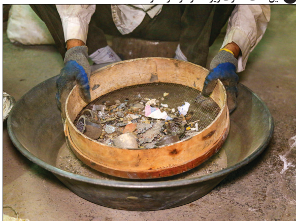
خاک‌ها ابتدا الک می‌شوند و قطعات درشت فاقد طلا از آن جدا می‌شود خاک‌های ذوب شده، سپس سرد می‌شوند تا بهتر، ذرات طلا را در آن‌ها پیدا کرد
